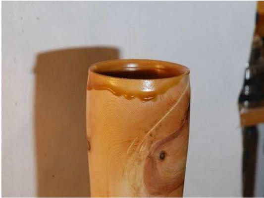
Das nach Außen gelaufene Pech kann nach dem Abkühlen leicht mechanisch abgeschält werden, da es ja auf dem bereits eingölten Holz lange nicht so gut haftet, wie auf dem bisher unbehandelten im Innenraum.
