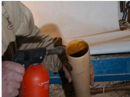
Am oberen Gefäßrand lasse ich das Pech durch nochmaliges Erhitzen mit einer Gasflamme (oder einem Heißluft-Föhn) schön verlaufen um einen sauberen Übergang zu erhalten.
