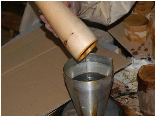
Ist die gesamte Innenseite unseres Wesbierholzes mit dem Pech benetzt, und der berschuss zurckgeschttet, sollte das Gef nun zum Abkhlen an einem ruhigen, staubfreien Platz abgestellt werden.
